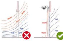
ders geformte Luftstrom legt sich unmittelbar vor die gesamte Türöffnung. Kalte Außenluft und warme Innenluft werden wie durch eine unsichtbare Tür wirkungsvoll voneinander getrennt. Kaltluft kann nicht hineinströmen und Warmluft nicht hinaus. Dieses System eignet sich auch für Kühlhäuser/Kühlbereiche
